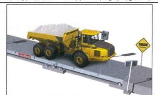
圖 7 施工車輛過磅檢測示意圖
